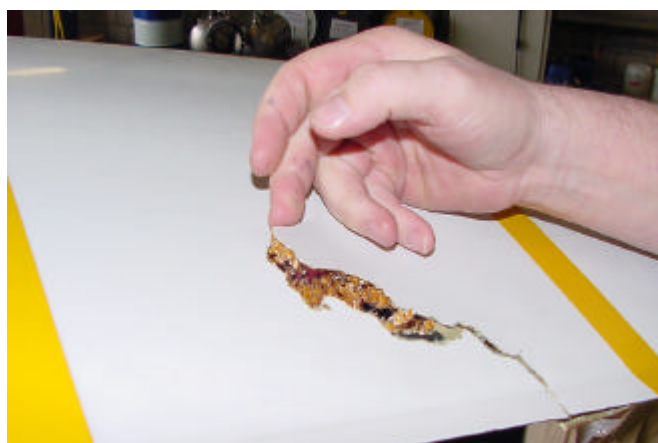
Beschadigde bovenzijde (voorrandsblad bovenaan foto)
